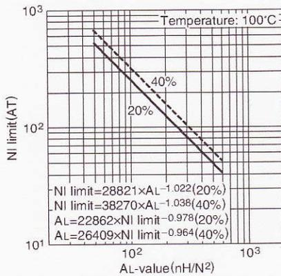
Note: このグラフに示されている限界線は、磁束に対する励磁電流の変化が直線である部分を延長し、それが20%および40%はずれた時の磁界の強さとAL-valueの関係を表わします。
