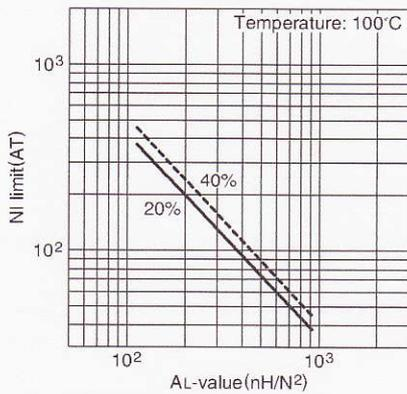
Note: このグラフに示されている限界線は、磁束に対する励磁電流の変化が直線である部分を延長し、それが20%および40%はずれた時の磁界の強さとAL-valueの関係を表わします。
